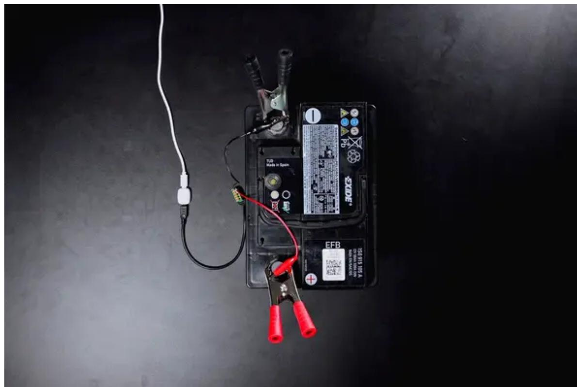
In kleinen batteriebetriebenen Set-ups können schon geringe Spannungsänderungen die Leistung und Zuverlässigkeit beeinflussen. Mit dem Analog Add-on wird The Pill von Shelly an Deine Spannungssensoren angeschlossen und liefert präzise Echtzeitmessungen. Egal ob 3,7?V, 4,2?V, 12?V, 24?V oder andere Niederspannungsquellen.
