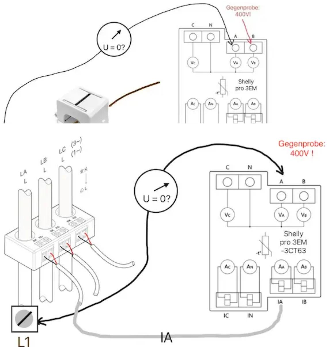
(a) Identifizierung von Stromwandler A: Nachverfolgung des weißen Kabels vom Stecker in Buchse IA zum Stromwandler.
