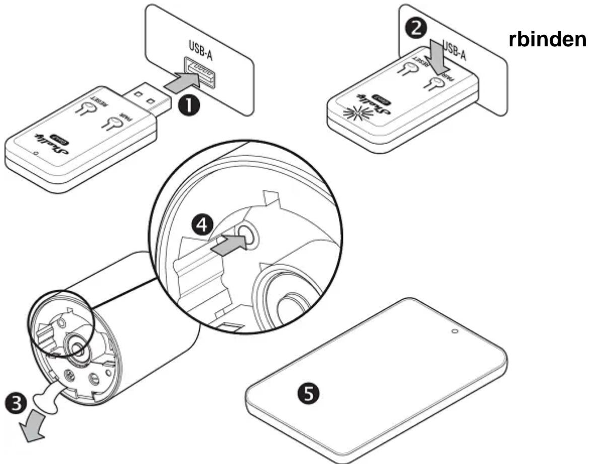
1. Stecken Sie [Shelly BLU Gateway Gen3](#) in einen Standard-USB-A-Anschluss (Netzteil ab 2A empfohlen).
