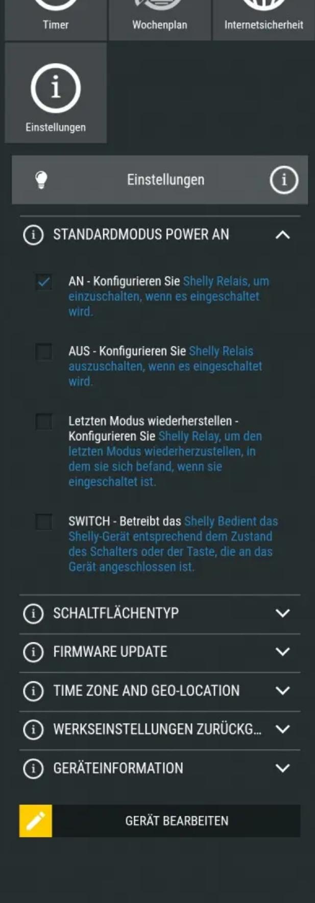
Lässt man den Shelly "eingeschaltet" so kann das Licht über die App oder per Hausautomation (z.B. [Homematic](#)) geschaltet werden. Auch alle weiteren App-Funktionen stehen zur Verfügung.
