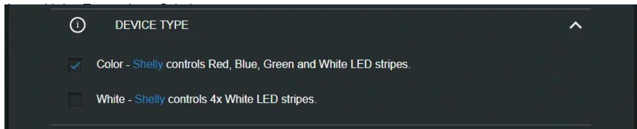
**Color:** Bei Anschluss eines RGB/RGBW LED-Streifens/Lampe
