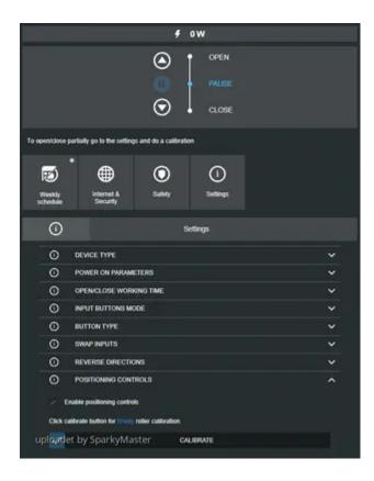
Wenn die Leistungsanzeige **0 Watt** beträgt, erkennt der <u>Shelly 2</u> / 2.5 das die OPEN-Position erreicht ist und kann mit der Kalibrierung beginnen.
